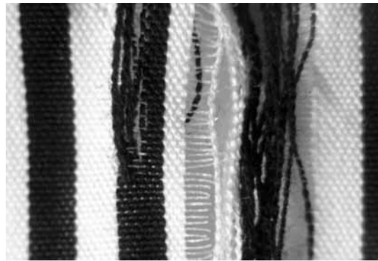
◀ヨコ糸のナイロンが軟化して機械力でタテに裂ける
