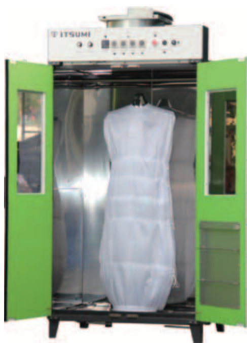
▲人体の肩幅や大きさ、エアバックの膨らみも細かく調整可能で、品物の変形を防ぐ
